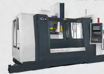
▲ 2070-H3L • Travel : X2000 Y700 Z700 mm • Table : L2150 × W700 mm
