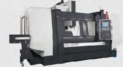
▲ 1890-3B • Travel : X1800 Y1000 Z900 mm • Table : L1950 x W900 mm
