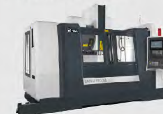
▲ 1570-3B • Travel : X1500 Y700 Z650 mm • Table : L1650 x W700 mm
