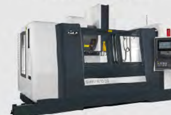
▲ 1670-3B • Travel : X1600 Y700 Z650 mm • Table : L1750 x W700 mm
