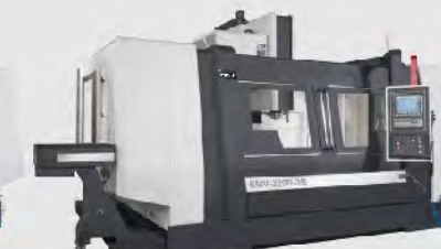
▲ 2290-3B • Travel : X2200 Y1000 Z900 mm • Table : L2350 x W1000 mm
