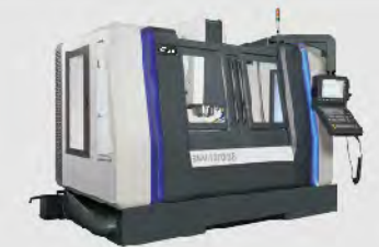
▲ 1270-3B • Travel : X1200 Y700 Z650 mm • Table : L1300 x W700 mm
