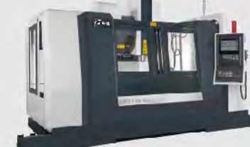
▲ 1670-H3L • Travel : X1600 Y700 Z700 mm • Table : L1750 × W700 mm
