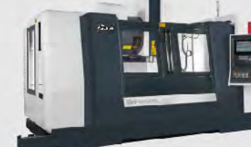
▲ 1570-H3L • Travel : X1500 Y700 Z700 mm • Table : L1650 × W700 mm
