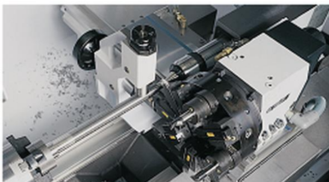
Lunette à suivre Mitlaufende Lünette Travelling steady 0180-70100-000
