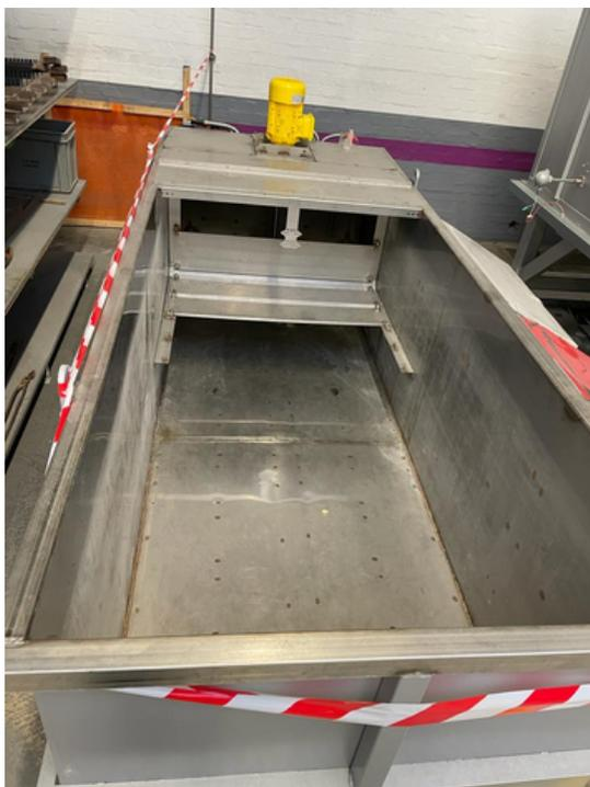
Elektrisch beheizter Umluftkammerofen und Wasserabschreckbad mit Umwälzung
