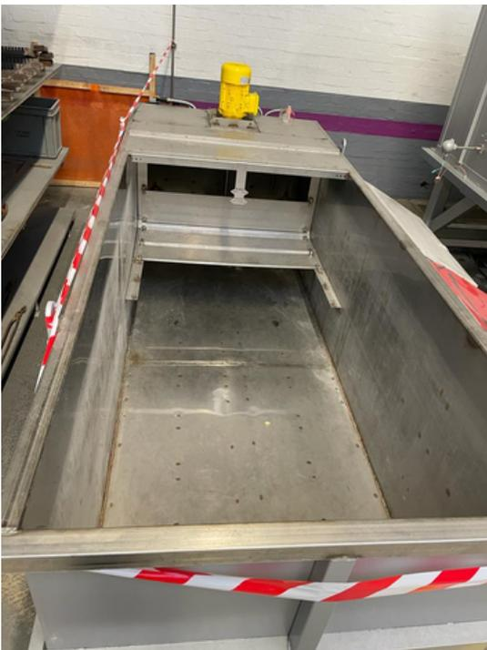
Elektrisch beheizter Umluftkammerofen und Wasserabschreckbad mit Umwälzung
